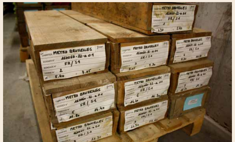
Les carottes du sondage préparatoire à la construction du métro bruxellois. Photo IRSNB
