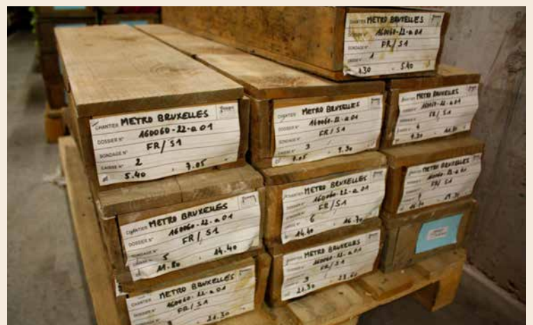
Boorkernen ter voorbereiding van de bouw van de Brusselse metro. Foto KBIN
